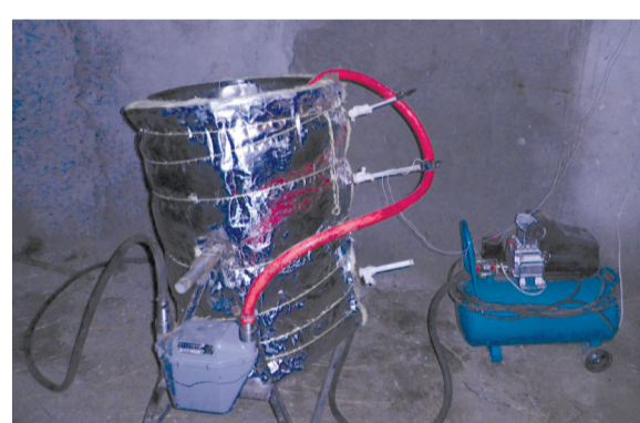
Սկ. 2. Գոմաղբի աերոբ արագացված ֆերմենտացման փոքրաչափ տեղակայանքի ընդհանուր տեսքն աշխատանքային վիճակում:
